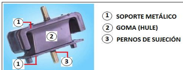
Figura 6. Elementos de la base motor
